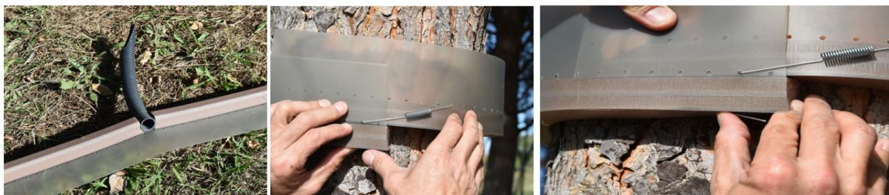
Insérez le tube de descente dans l'espace prévu dans la mousse. **L'extrémité supérieure** du tube de descente doit **araser la mousse**.
